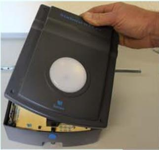
Die 4 Schrauben von der Abdeckung lösen und Abdeckung abnehmen
