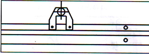
Entfernen Sie den bestehenden Magneten vom Zahnstangenprofil (nur bei Nachrüstung der Abdeckhaube Comfort 820 notwendig).
