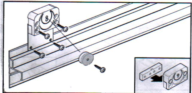
Montieren Sie den Halter auf die Zahnstange.
