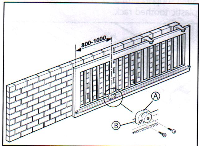
Montieren Sie den Magneten mit Magnethalter (A) aufsitzend auf dem Zahnstangenprofil (B).
