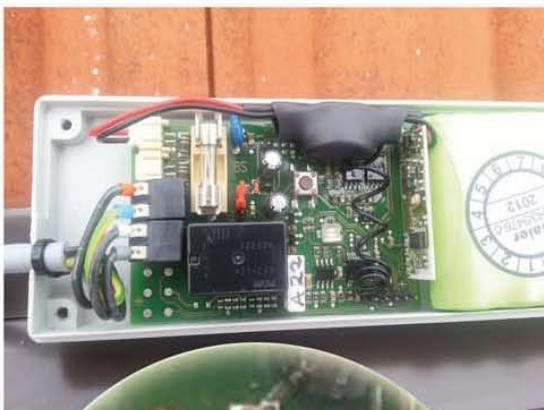
und aktivieren den Akku durch umstecken vom roten Jumper auf die Pins, damit die Brücke geschlossen wird.
