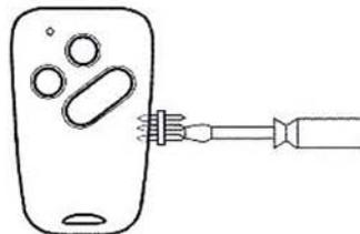
3. Halten Sie die betreffende Kanaltaste ca. 5 Sekunden gedrückt. Der Kanal wird neu codiert (Zufallsprogrammierung).
