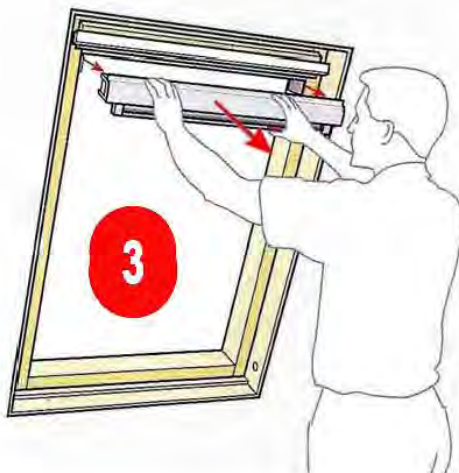
Führungsschienen durch Herausdrehen sämtlicher Schrauben lösen. (Torx Größe 8)
