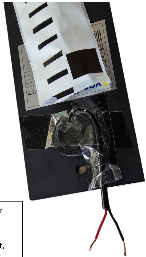
Beim Neuen Solarpanel die beiden Adern abisolieren.
