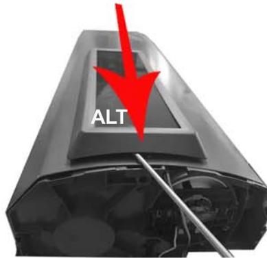
Solarpanel kräftig 2 cm zur Motorseite schieben
