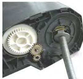
\*Sollte das Kunststoffteil am anderen Ende der Feder auch abgebrochen sein, so muß dies nicht unbedingt aus der Welle entfernt werden!
