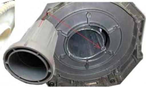
Danach die abgebrochene Feder aus der Welle entfernen! Diese liegt meistens lose weiter Innen, Spitzzange oder sonstiges verwenden um diese heraus zu holen
