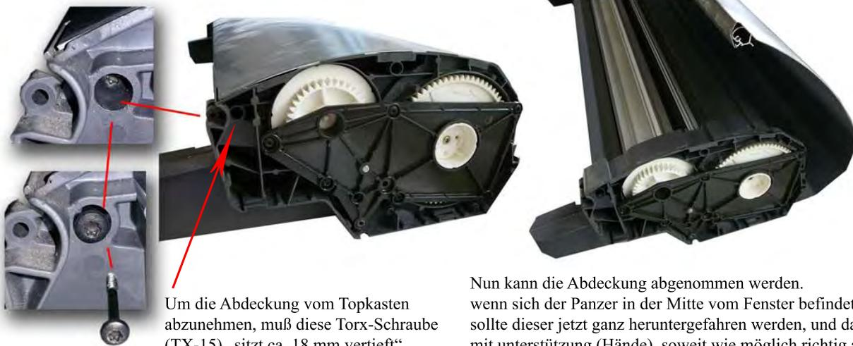
Um die Abdeckung vom Topkasten abzunehmen, muß diese Torx-Schraube (TX-15) „sitzt ca. 18 mm vertieft“ beidseitig herausgedreht werden
