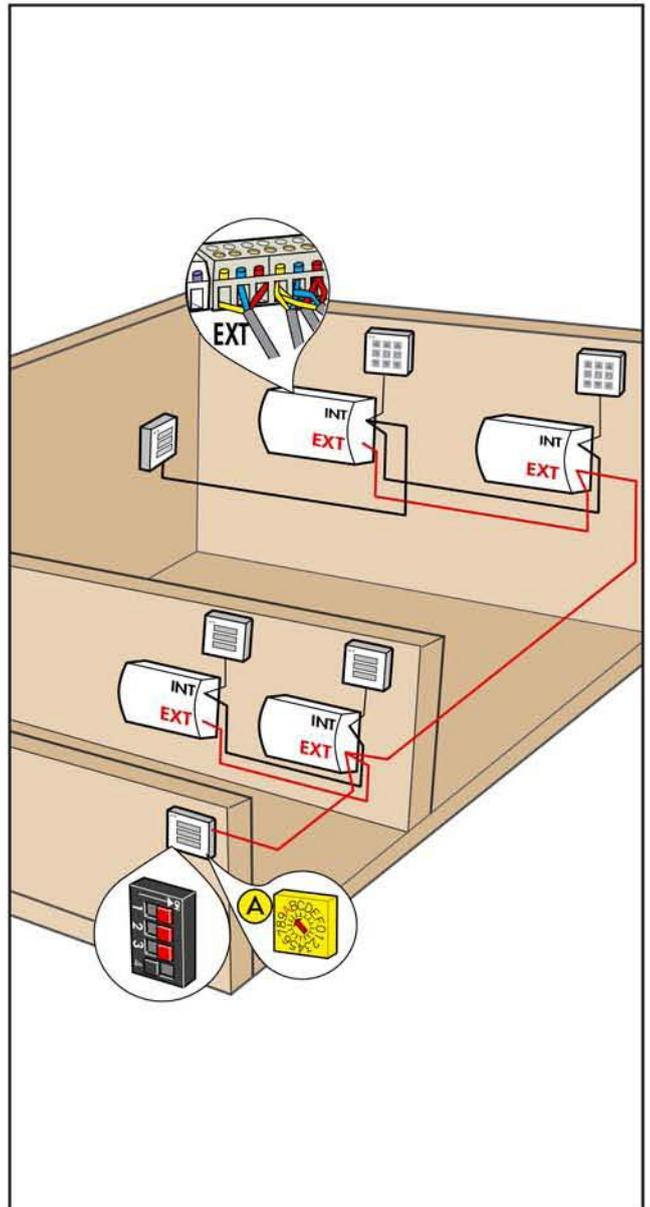
**Deutsch: Mehrere Gruppen** können mit der 3-adrigen Leitung WLL 100 zusammengeschaltet werden, so daß alle Motoren von einer zentralen Bedienungstastatur bedient werden können. Die zentrale Bedienungstastatur wird an den Eingang "EXT" von einer der Steuereinheiten angeschlossen, und der Codierschalter an der Bedienungstastatur wird auf "A" eingestellt. Bis zu 32 Steuereinheiten können zusammengeschaltet werden.
