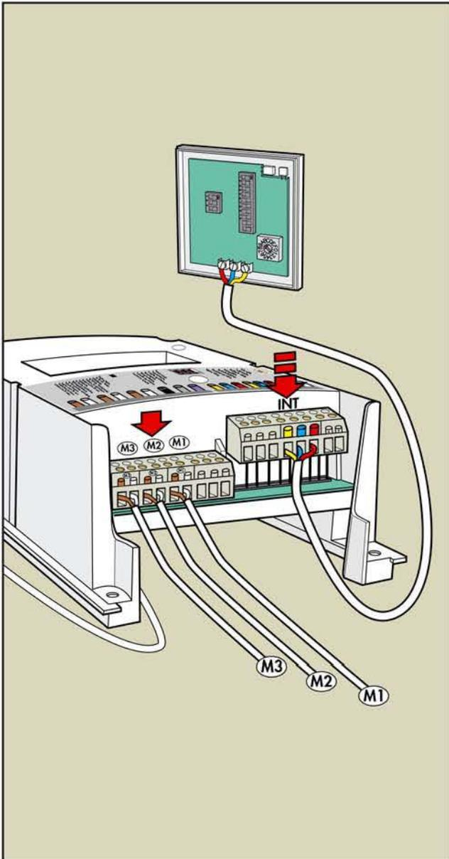
**Deutsch:** Drei Motoren können von einer einzigen Bedienungstastatur individuell bedient werden. Die Bedienungstastatur hat drei Tastenreihen; jede Reihe bedient einen Motor.
