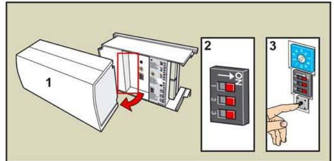
**Deutsch:** Falls die Fernbedienung abhanden gekommen ist oder falls sie nicht funktioniert, kann das Fenster auf folgende Weise geschlossen werden: Den Deckel der Steuereinheit entfernen (1). Den Umschalter auf Position "ON" setzen (2). Den schwarzen Knopf drücken (3).
