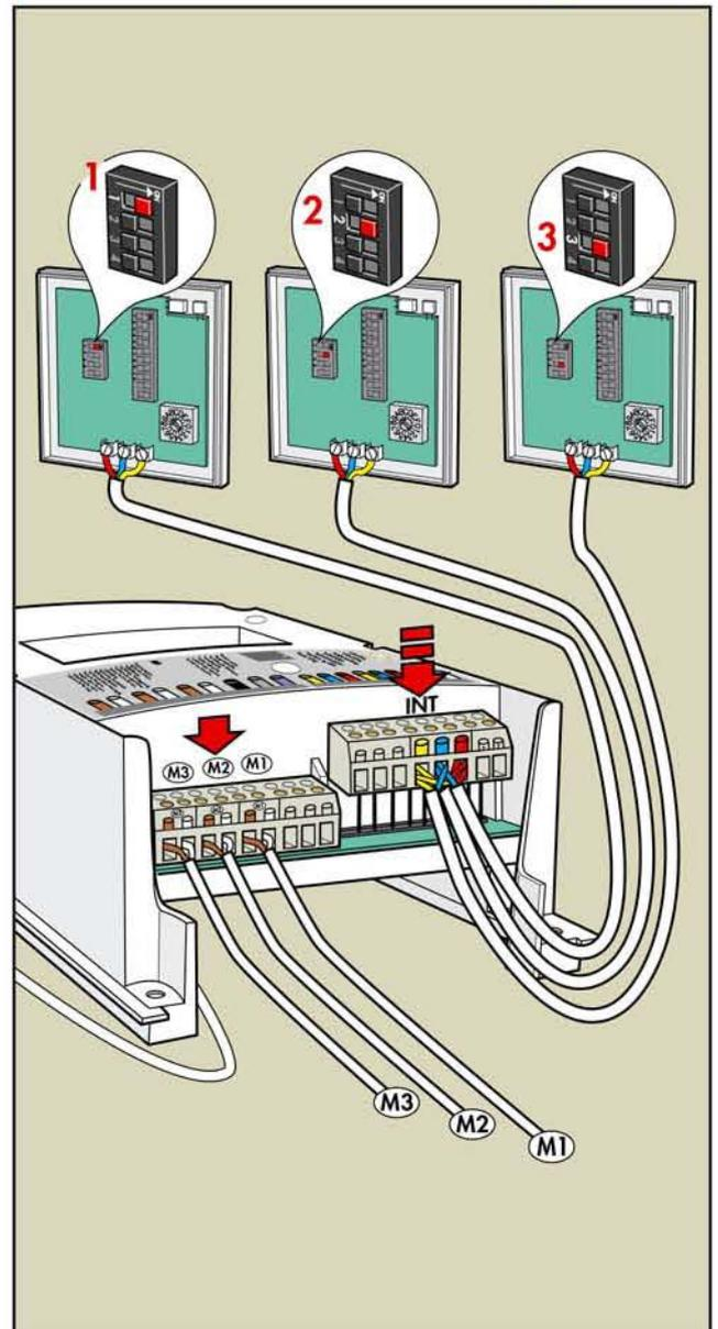
**Deutsch:** Drei Motoren können von separaten Bedienungstastaturen individuell bedient werden. Die Tastaturleitungen an den Eingang "INT" der Steuereinheit anschließen. Den Umschalter der jeweiligen Bedienungstastatur für den gewünschten Motor (1, 2, 3) auf "ON" setzen.
