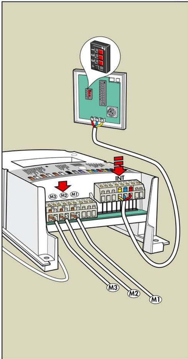
**Deutsch:** Drei Motoren können mit einem Tastendruck auf der gemeinsamen Bedienungstastatur bedient werden; die Motoren werden nach einander aktiviert. Wenn der Umschalter 1, 2 und 3 der Bedienungstastatur auf "ON" gesetzt wurde, die Tastaturleitung an den Eingang "INT" der Steuereinheit anschließen.
