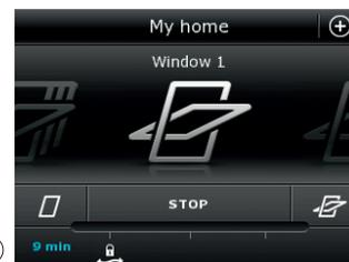
**Hinweis:** Wenn Sie versuchen ein Fenster zu öffnen, während es regnet, wird nur die Lüftungsklappe geöffnet. Diese Funktion verhindert, dass der Regen eintritt. Tippen Sie auf "OK" wenn dieses in Ordnung ist. Tippen Sie auf "Öffnen", wenn Sie das Fenster öffnen möchten, auch wenn es regnet. Das Fenster wird nun auf die gewünschte Position angesteuert, jedoch nicht mehr als halbwegs (50%). Nach Ablauf von 15 Minuten wird das Fenster, wenn es noch regnet, wieder geschlossen.
