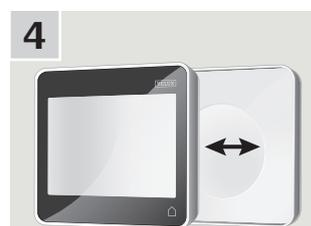
Legen Sie das Control Pad in die Halterung. Das Control Pad wird mittels eingebauter Magnete gesichert.
