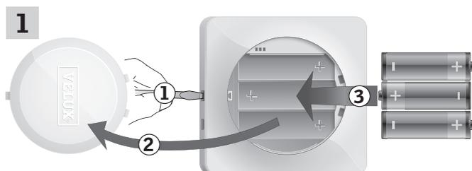
Lösen Sie den Batteriedeckel durch Drücken der Entriegelungstaste mit einem Schraubendreher wie in der Abbildung gezeigt ①, ②. Legen Sie die Batterien ein (Typ AA/LR6) ③.
