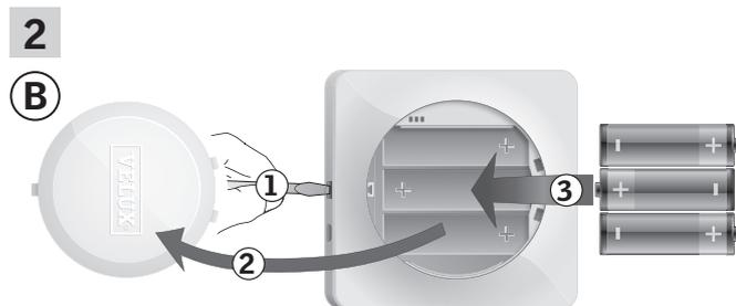
Lösen Sie den Batteriedeckel durch Drücken der Entriegelungstaste mit einem Schraubendreher wie in der Abbildung gezeigt **1**, **2**. Legen Sie die Batterien ein (Typ AA/LR6) **3**.
