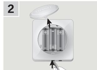
Lösen Sie den Batteriedeckel durch Drücken der Entriegelungstaste mit einem Schraubendreher wie in der Abbildung gezeigt.
