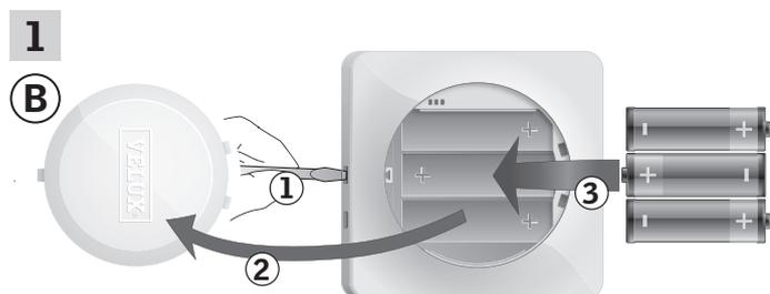
Lösen Sie den Batteriedeckel durch Drücken der Entriegelungstaste mit einem Schraubendreher wie in der Abbildung gezeigt **1**, **2**.
