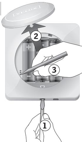
Lösen Sie den Batteriedeckel durch Drücken der Entriegelungstaste mit einem Schraubendreher wie in der Abbildung gezeigt wird ①, ②. Drücken Sie die RESET-Taste auf der Rückseite des Control Pads mindestens 5 Sekunden mit einem spitzen Gegenstand ③.
