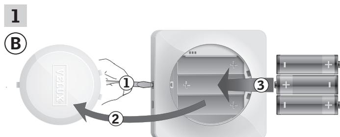
Lösen Sie den Batteriedeckel durch Drücken der Entriegelungstaste mit einem Schraubendreher wie in der Abbildung gezeigt ①, ②.
