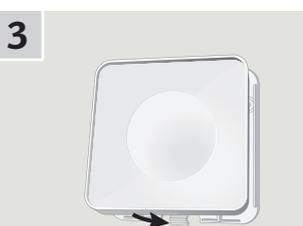
Rasten Sie die Halterung an der Rückenplatte ein.
