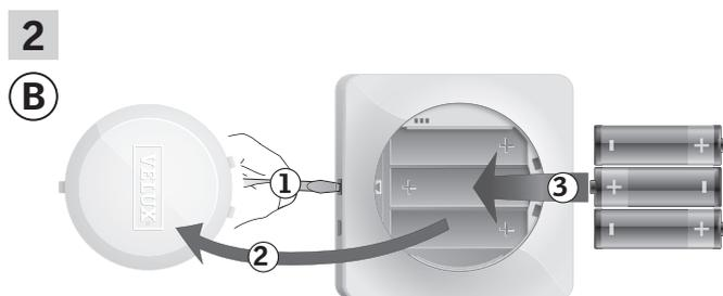
Lösen Sie den Batteriedeckel durch Drücken der Entriegelungstaste mit einem Schraubendreher wie in der Abbildung gezeigt **1**, **2**.
