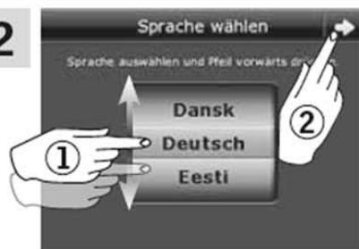
Wählen Sie eine Sprache. Drehen Sie das Rad, indem Sie einen Finger über das Display in die Pfeilrichtungen führen ①.
