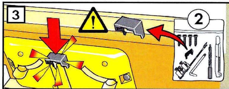
**Deutsch:** Lüftungklappe schließen (1). Lüftungsklappenbeschlag mit Schrauben befestigen (2). ⚠ Magnet auf den Verschluss platzieren (3).
