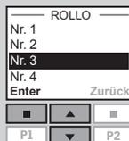
Wenn ein Fenster mit einer Fernbedienung geöffnet wurde, können Sie es so einstellen, dass es nach einer bestimmten Zeit automatisch wieder schließt. Vielleicht wollen Sie z. B. Ihr Haus nach der Rückkehr von der Arbeit kurz belüften. Die möglichen Einstellungen sind: Aus, 5 Min., 10 Min., 15 Min., 20 Min., 30 Min., 45 Min. und 60 Min.
