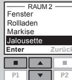
5 Eine Liste der Produkte der ausgewählten Produktart wird angezeigt. Die jeweiligen Produkte können identifiziert werden, indem Sie kurz drücken. Das Produkt wird kurz aktiviert.
