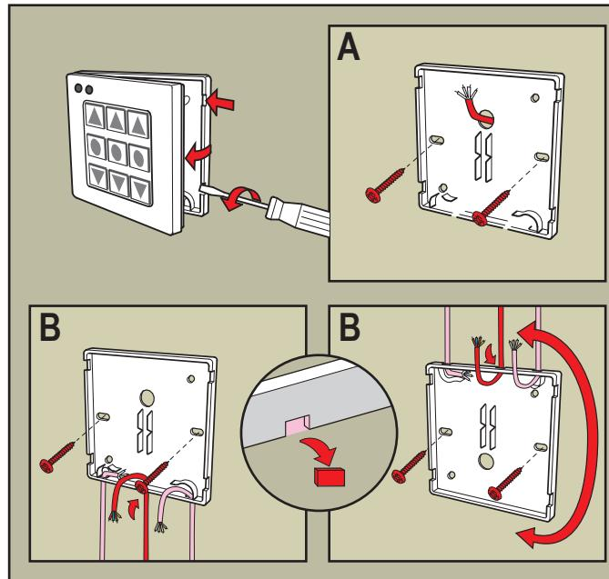
**Nederlands:** Bevestig het bedieningspaneel WLI 130 aan de wand. **Verborgen bedrading (A):** Trek de kabel door het gat in de onderplaat. **Zichtbare bedrading (B):** Bepaal waar u de kabel naar binnen wilt brengen. Maak de opening in het bedieningspaneel op de gewenste plaats door het dunne gedeelte eruit te drukken. Als de kabel aan de bovenzijde binnen komt dient u de onderplaat 180° te draaien.
