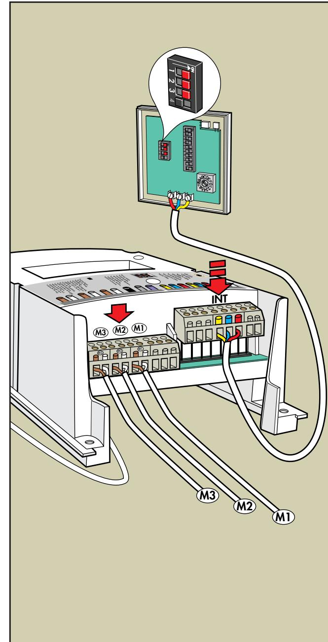
**Nederlands:** Drie motoren kunnen afzonderlijk bediend worden vanaf hetzelfde bedieningspaneel. Het paneel heeft drie rijen met knoppen; elke rij stelt een andere motor in werking.
