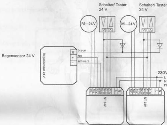
5) 2x 24 V - 1x Schalter/ Taster - 1x Regensensor (Typ: ZEL STG RS 24 V)
