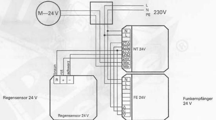
4) 2x 24 V - 2x Schalter/ Taster - 1x Regensensor (Typ: ZEL STG RS 24 V)
