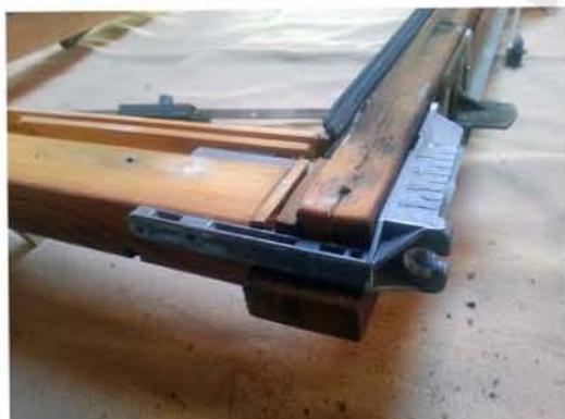
**Der untere Schenkel von der Neuen Umlenkung ist ca. 3 cm länger, so das man nun einen besseren Halt im Holz bekommt. Evtl. vor dem Zusammenbau das Holz zusätzlich mit einem Holzschutzmittel behandeln!**
