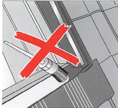
Die elastischen Kunststoffdichtungen dürfen auf keinen Fall überstrichen werden, weil ihre Dichtungsfunktion dadurch verloren geht.
