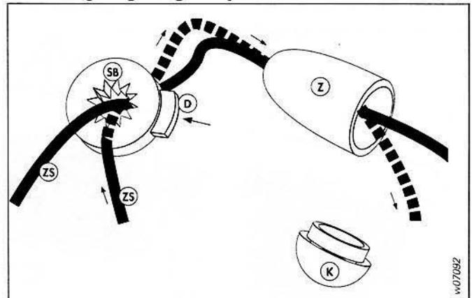
Abb. 8: Zugknopf / Schnurbremse befestigend
