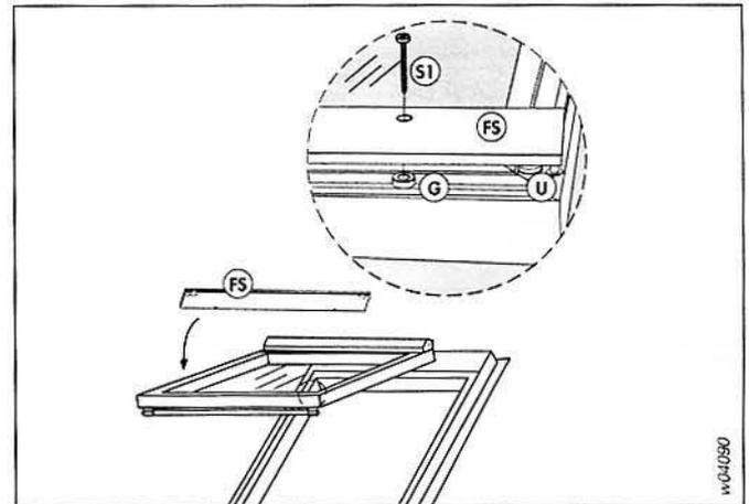
Abb. 6: Führungsstab montieren
