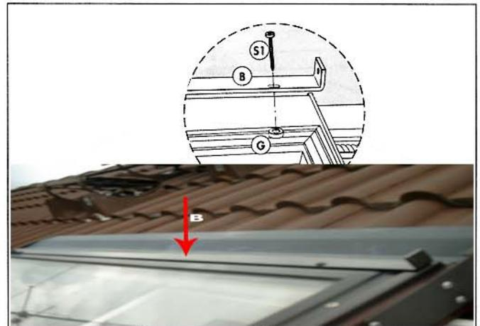
Abb. 3: Befestigungsbügel anbringen
