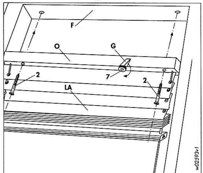
Abb. 4: Oberschiene befestigen
