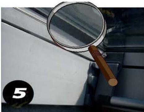
Glasscheibe wieder montieren, beim einsetzen der Scheibe darauf achten das sich die Dichtung nicht verdreht. **Achtung:** Es darf sich kein Schmutz, oder Sandkorn auf der Neuen Dichtung befinden, ansonsten besteht die Gefahr das die Scheibe beim eindrehen der Befestigungsschrauben (oder zu einem späteren Zeitpunkt) einen Sprung bekommt.
